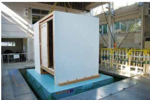
振動実験における装置全景
