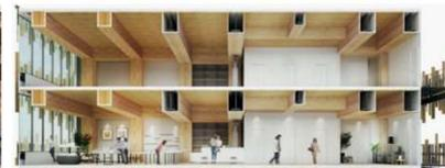
スプリンクラー+機械排煙で内装制限の規定を適用しない計画事例
