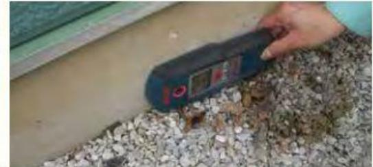
鉄筋探知機を用いて配筋調査
