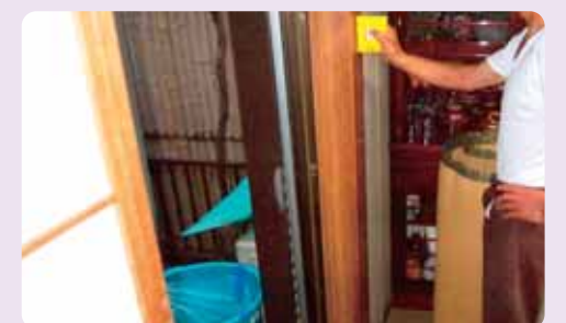
8 下げ振りで家全体の傾きを調べます。一定方向に広範囲に傾いているか調査します。
