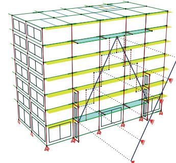
○特殊な座屈止めを有する一組の大きなプレースのデザインを採用することで、複数の階を合理的に補強し、環境の良い南側の眺望や採光を遮る部分を少なくし、住もう人にとって良好な住環境をできる限り維持しながら、建築材料の縮減と機能性の確保を同時に実現しています。
