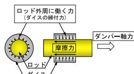
金属同士の締付による摩擦力で地震エネルギーを熱工
