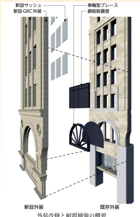
外装改修と耐震補強の概要
