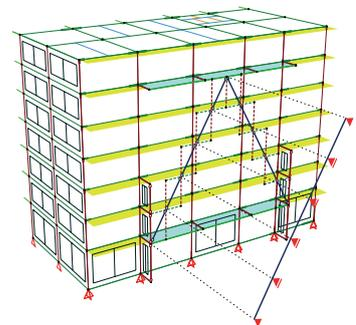
○特殊な座屈止めを有する一組の大きなブレースのデザインを採用することで、複数の階を合理的に補強し、環境の良い南側の眺望や採光を遮る部分を少なくし、住まう人にとって良好な住環境をできる限り維持しながら、建築材料の縮減と機能性の確保を同時に実現しています。
