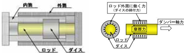
金属同士の締付による摩擦力で地震エネルギーを熱エネルギーに変換。繰返しの地震にも性能発揮
