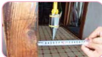
下げ振りで柱の傾きを調査
