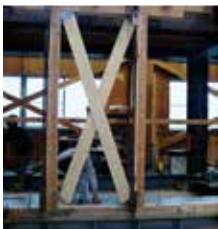
耐力量加力試験風景
